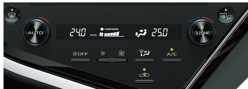
Ar-condicionado digital three zone com controle de temperatura independente para motorista, passageiro dianteiro e bancos traseiros e nova tecnologia S-Flow, que identifica quais bancos estão ocupados, direcionando o fluxo de ar
